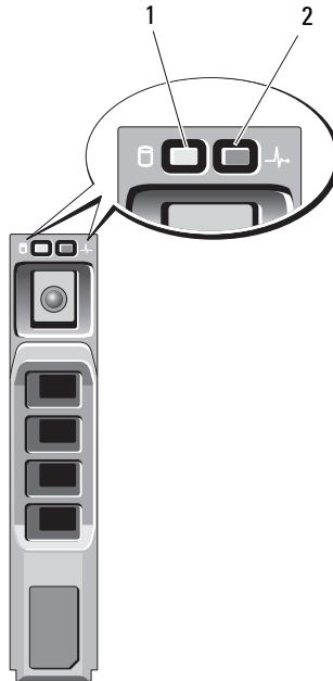
Ilustración 1-4. Indicadores de la unidad de disco duro
